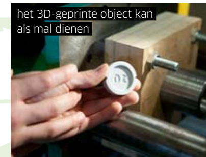
kunststof wordt in de mal gespoten
