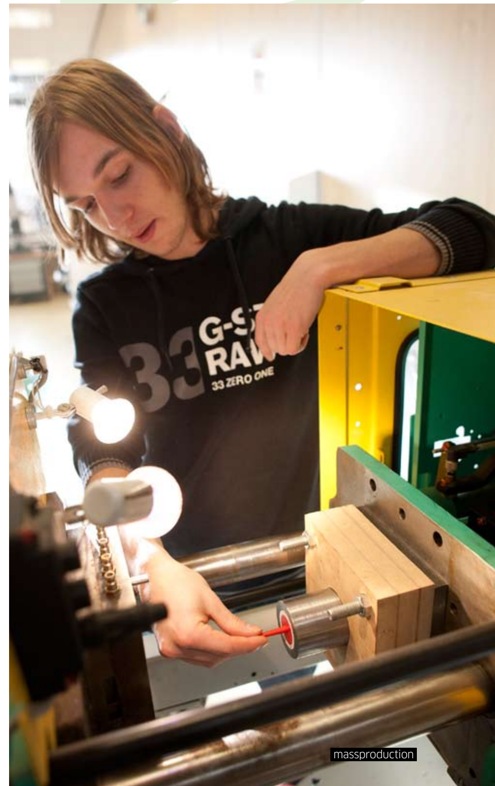
kunststof wordt in de mal gespoten
